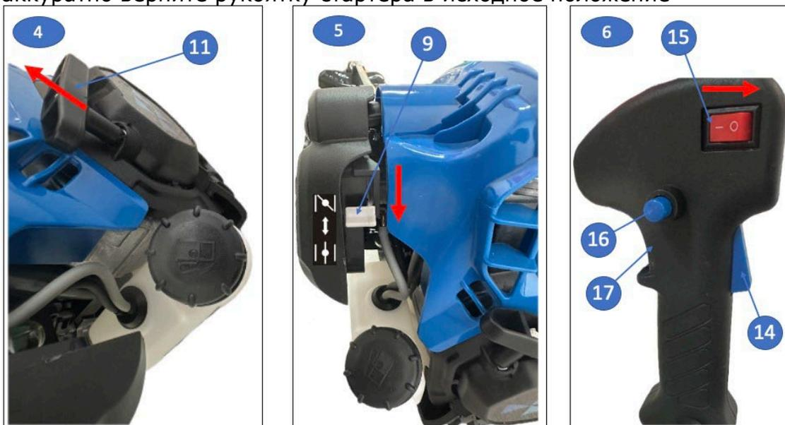
5. **Важно!** После того, как двигатель откликнется, установите рычаг дроссельной заслонки (9) в положение прогретого пуска (открыто) и снова потяните ручку стартера, пока двигатель не запустится.
