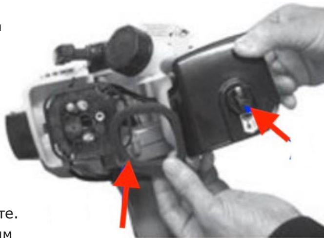
Установите на место воздушный фильтр и крышку воздушного фильтра.
