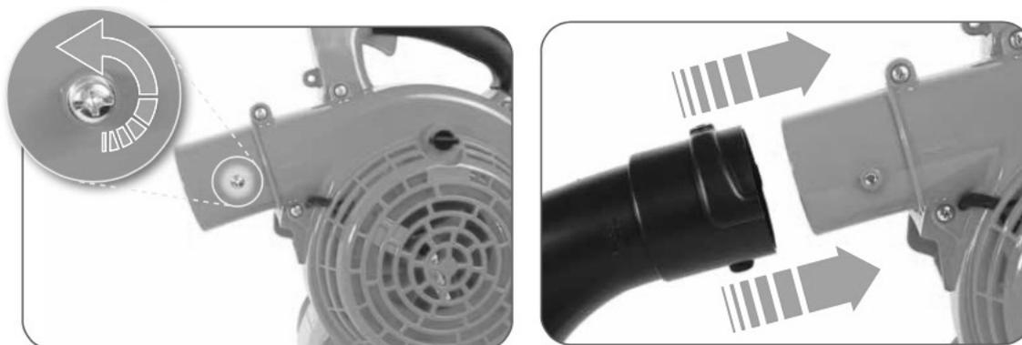
Поверните трубку против часовой стрелки, совместите отверстие в трубке с резьбовым отверстием на корпусе воздуходувки.
