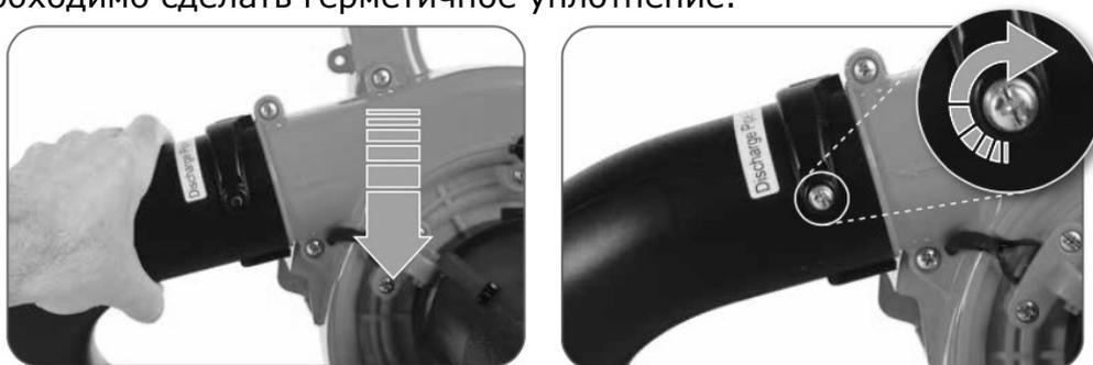
Поверните и зафиксируйте нагнетательную трубу, чтобы она надежно зафиксировалась на основном корпусе. После того, как напорная труба расположена правильно, замените крепежный винт.
