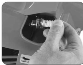
Очистите камеру сгорания от излишков топлива, несколько раз потянув за шнур стартера при снятой свече зажигания.
