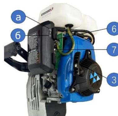
Возьмите пусковую рукоятку стартера (3). Крепко удерживая ее в руках, плавно потяните шнур стартера, пока барабан стартера не войдет в сцепление с собачками храпового механизма. Только после этого сделайте плавный резкий, но не длинный рывок. При этом шнур вытягивается примерно на 2/3 длины. Плавно, не отбрасывая рукоятку, опустите руку вниз, позволив шнуру вновь вернуться в барабан.
