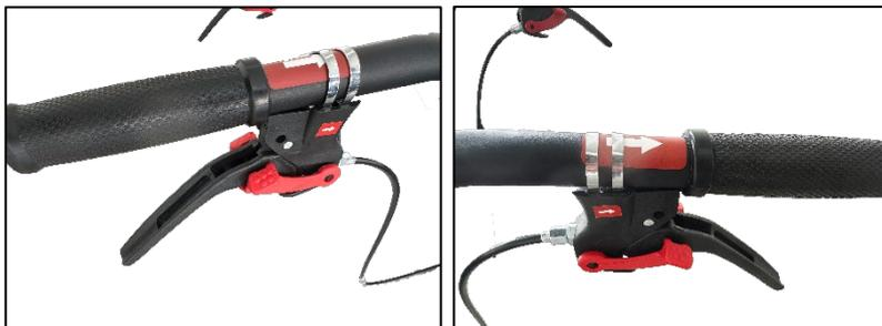
Установите выключатель остановки и ручку регулировки скорости.
