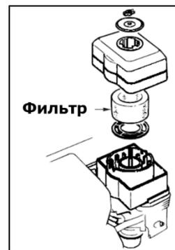
**⚠ ПРЕДУПРЕЖДЕНИЕ!** Никогда не работайте без воздушного фильтра, с грязным или поврежденным воздушным фильтром. Пыль и грязь будут попадать в двигатель, что приведет к его поломке. Выход из строя двигателя по этой причине не подлежит гарантийному ремонту. Держите воздушный фильтр чистым!
