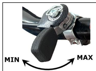
**⚠ ПРЕДУПРЕЖДЕНИЕ!** Новый Мотокультиватор бензиновый должен работать на низких или средних оборотах в первые 20 часов работы. Для продления срока службы рекомендуем не использовать устройство на максимальных оборотах.
