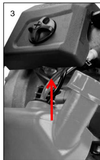
2. Переведите рычаг воздушной заслонки в положение холодного пуска («KALTSTART»).
