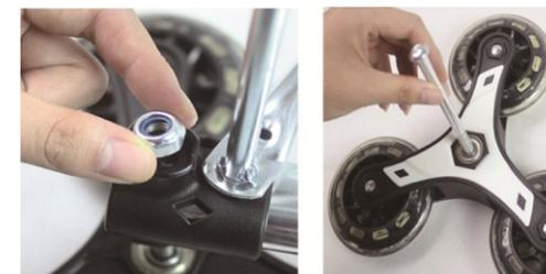
Колесо крепится длинным болтом и гайкой к корпусу тележки.
