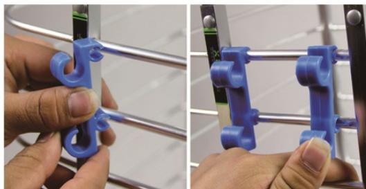
Нагрейте пластиковые крюки в горячей воде для удобства фиксации на проволочных элементах
