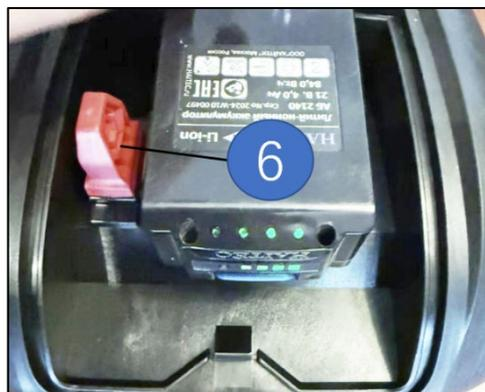
**!** **ВНИМАНИЕ!** Будьте осторожны, чтобы не потерять выключатель защиты от непреднамеренного включения. Если ключ отсутствует, не используйте какие-либо другие устройства для блокировки защиты от случайного включения.
