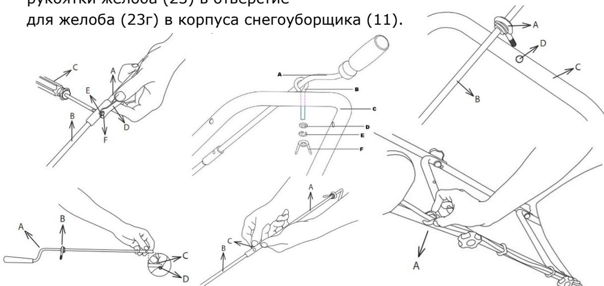
Снимите шайбу и гайку с O образного болта держателя (56) с помощью резиновой втулки, найденной на верхней рукоятке желоба.
